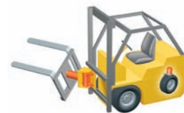
Gabelstapler Gabelschwenkung, Drehung von Sonderzubehör, Lenkung
