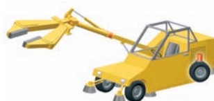
Landwirtschaftliche Erntemaschinen Auslegerpositionierung, Kopfdrehung, Radsteuerung
